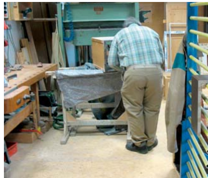
Vorher: der Handarbeitsplatz vor der Furnierpresse stört den innerbetrieblichen Transport
